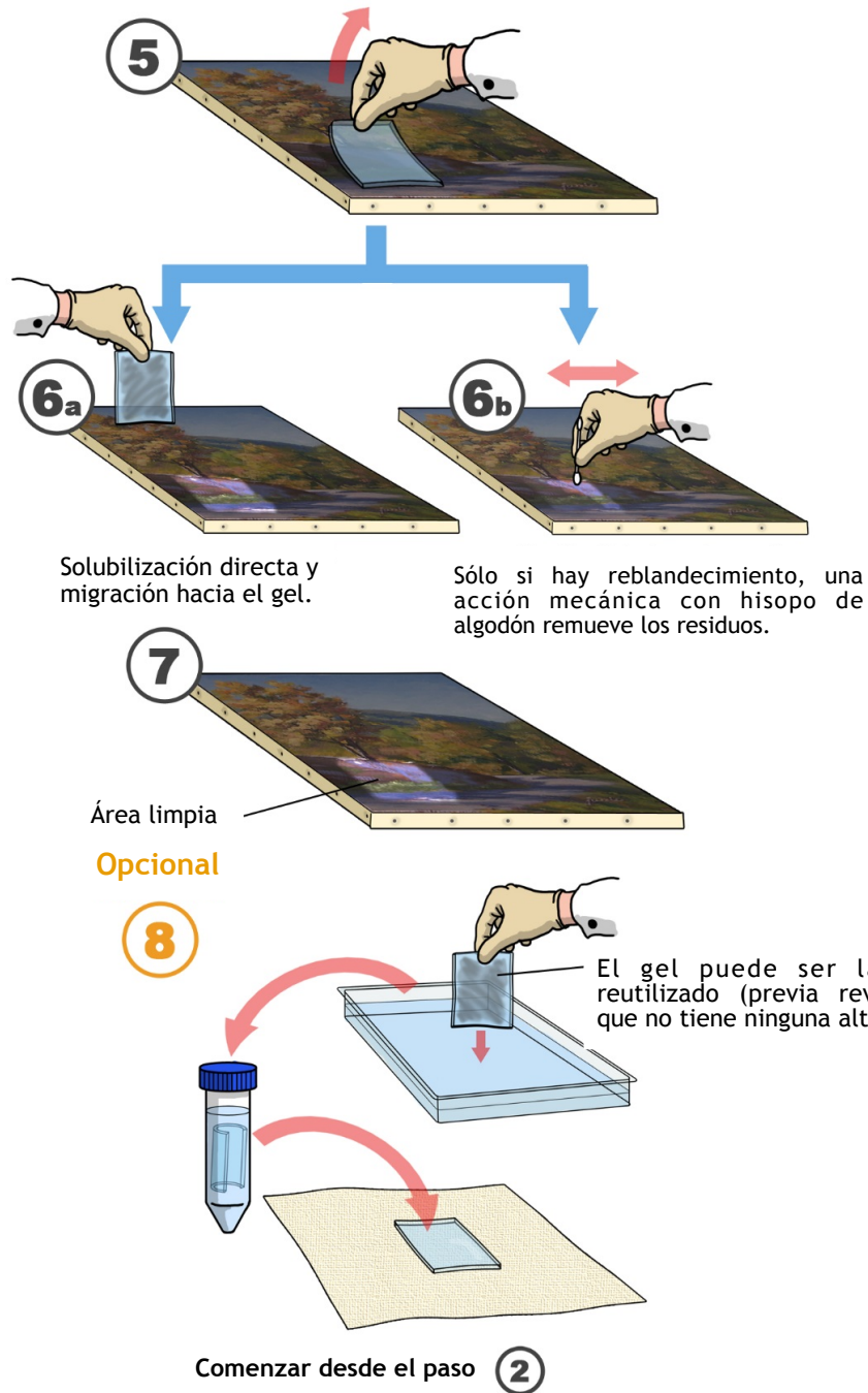
Figura 1b. Aplicación de Nanorestore Gel® Peggy para la remoción de suciedad hidrosoluble.
